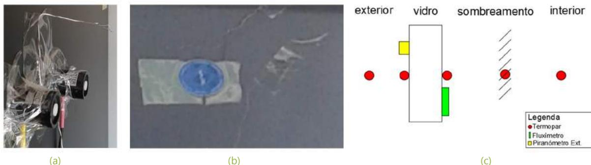
Figura 2: Equipamentos utilizados nos gabinetes: a) luxímetro (fio amarelo) e piranómetro (fio vermelho) verticais e termopar; b) fluxímetro colado na superfície interior do vidro (visto do exterior); c) corte esquemático com a posição dos termopares, piranómetro e fluxímetro
