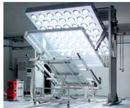
dor solar, simulador solar, câmara climática, equipamento de carga mecânica, equipamento de pressão interna, equipamento de penetração de chuva, equipamentos de medição elétrica, câmara de luminescência e diversos equipamentos de medição de condições climáticas).
