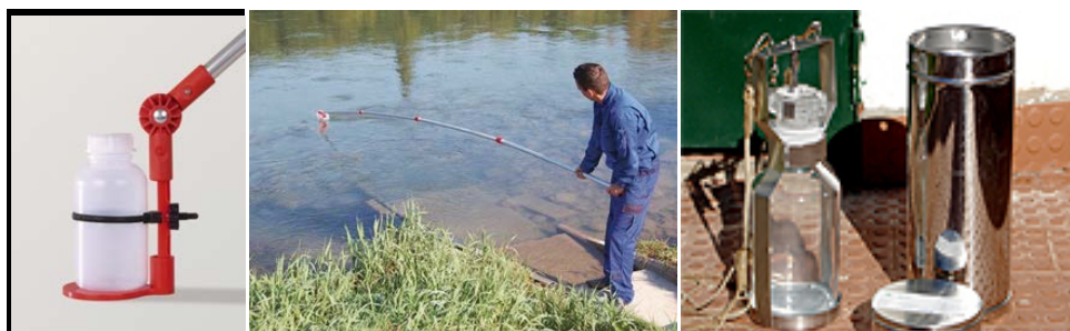
Figura 10 – Colheita indireta de amostras com varão extensível ou frasco de mergulho
