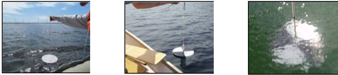
Figura 7 – Medição da profundidade de Secchi
