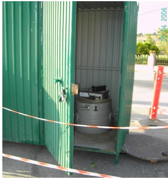
Figura 17 – Exemplo de colheita no ponto de ligação de um efluente industrial à rede de coletores
